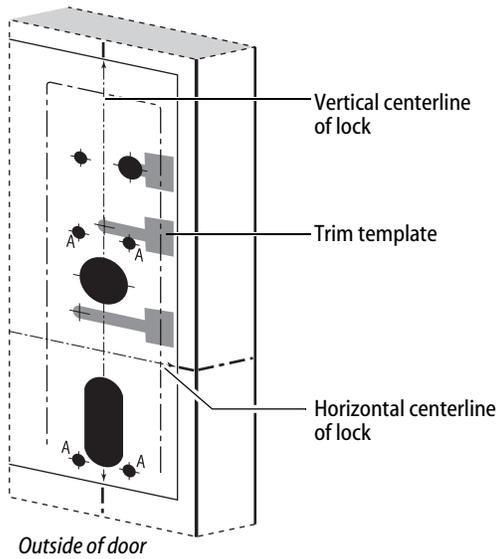
Figure 8 Positioning the trim template, Q08 LHRB shown
