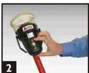
2 Zum Einschalten den roten Schalter drücken. Die LED leuchtet grün. Langsames Blinken zeigt Ruhebetrieb (Standby) an.
