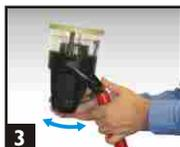
3 Ajuste el ángulo del comprobador con la palanquita inferior y colóquelo sobre el detector.
