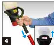
4 Solo 330 über den zu prüfenden Melder halten. Achten Sie darauf, dass der Melder ganz umschlossen ist. Durch leichtes Drücken gegen die Decke Sprühstoß auslösen (ca. 1 Sekunde).
