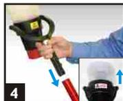
4 Inserte el Solo 330 en el tubo. Coloque la campana del Solo 330 sobre el detector, verificando que haya una buena obturación alrededor de la cámara de humo.
