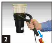
2 Prüfgerät auf Solo-Stange aufsetzen. Befestigungsclip. 423/4 auf Stange aufsetzen.
