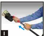
1 Einen aufgeladenen Akku-Stab in Werkzeug und Stange einführen.
