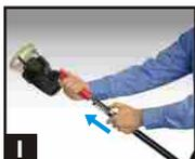
1 Inserte una batería entre el comprobador y el tubo.
