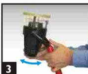
3 Die Prüfgerätposition einstellen und Prüfgerät über den Melder halten.
