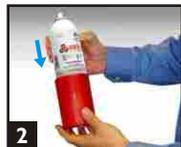
2 Coloque el bote de aerosol en el vaso.
