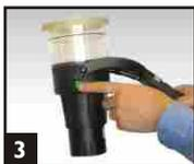
3 An Netzspannung anschließen, einschalten (grüner Schalter) und über den Melder halten.
