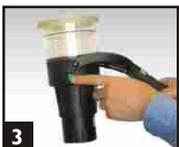
3 Inserire il 423/4 nel palo. Premere l'interruttore. Posizionare sotto il Rilevatore.
