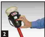
2 Per l'accensione premere l'interruttore rosso. Il LED si illumina con una luce verde. Un lampeggio lento indica un funzionamento normale e una condizione di STANDBY.
