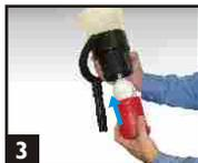
3 Vuelva a colocar el vaso y enrosque hasta que se active el aerosol. Retroceda ligeramente hasta que no salga gas.
