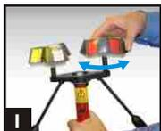
1 Regulación de los cabezales triangulares. Estire y gire.
