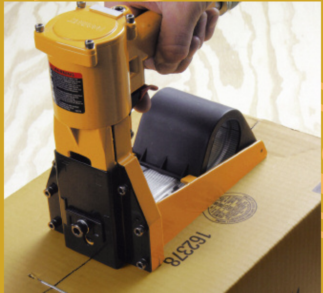
D61ADC Sealing carton lid
